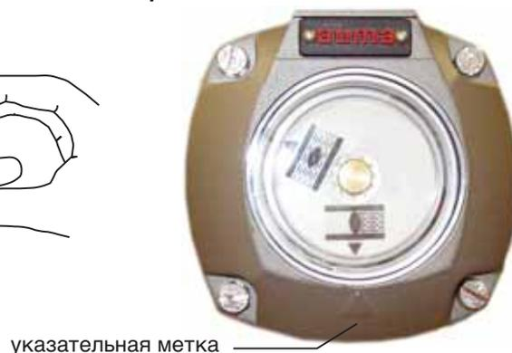
Указательный диск делает примерно от 180° до 230° при полном перемещении из положения ОТКРЫТО в положение ЗАКРЫТО или наоборот. Соответствующая понижающая передача встраивается на заводе. В случае последующего изменения отношения – число оборотов / ход – возможно потребуется заменить понижающую передачу.
