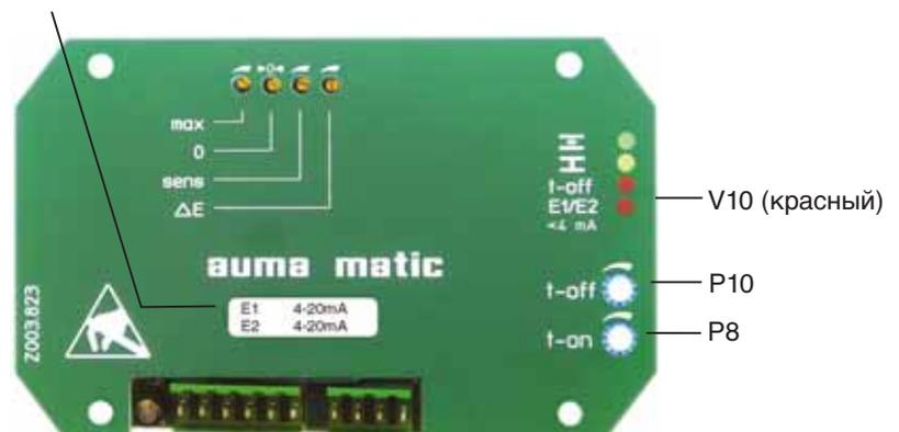
рис S2: Плата регулятора положения A7
