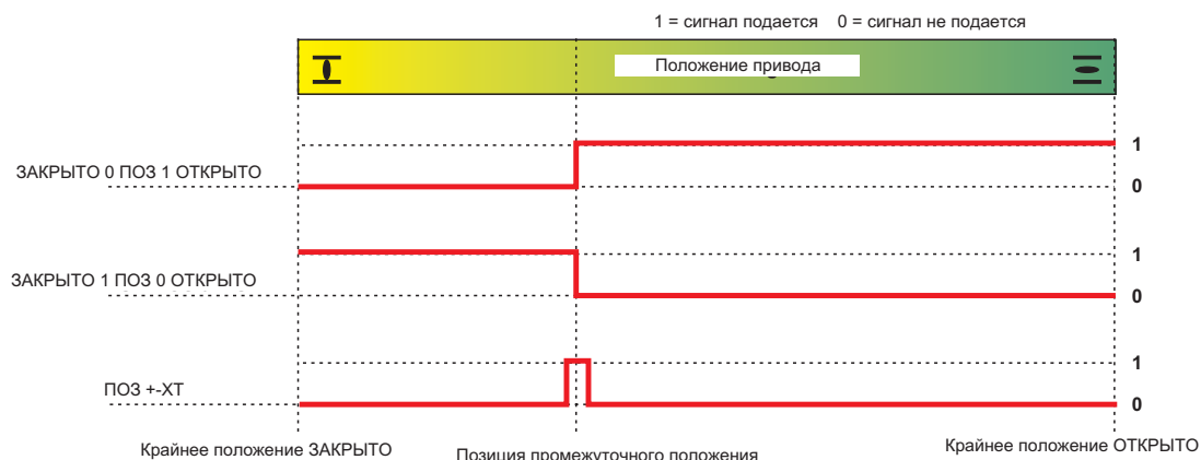
Рис. L3: Сигналы промежуточных положений номер 0-2 (см. таблицу ниже)
